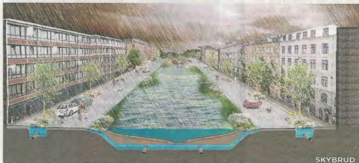
Eine variable Infrastruktur soll Schäden vorbeugen: Bei gutem Wetter eine Liegewiese, bei starkem Regen ein Kanal. FOTO: RAMBOLL STUDIO DREISEITL
